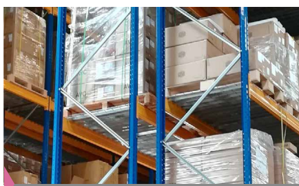
捷克廠 - 層架加裝側邊防護以防止貨物掉落
