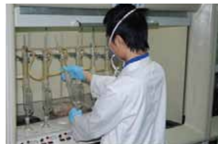
索式提取有機物中的多溴聯苯及多溴聯苯醚
