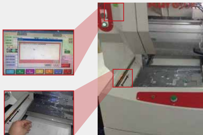
■ 對設備運動部分無法封閉的，用紅外線安全sensor進行保護
